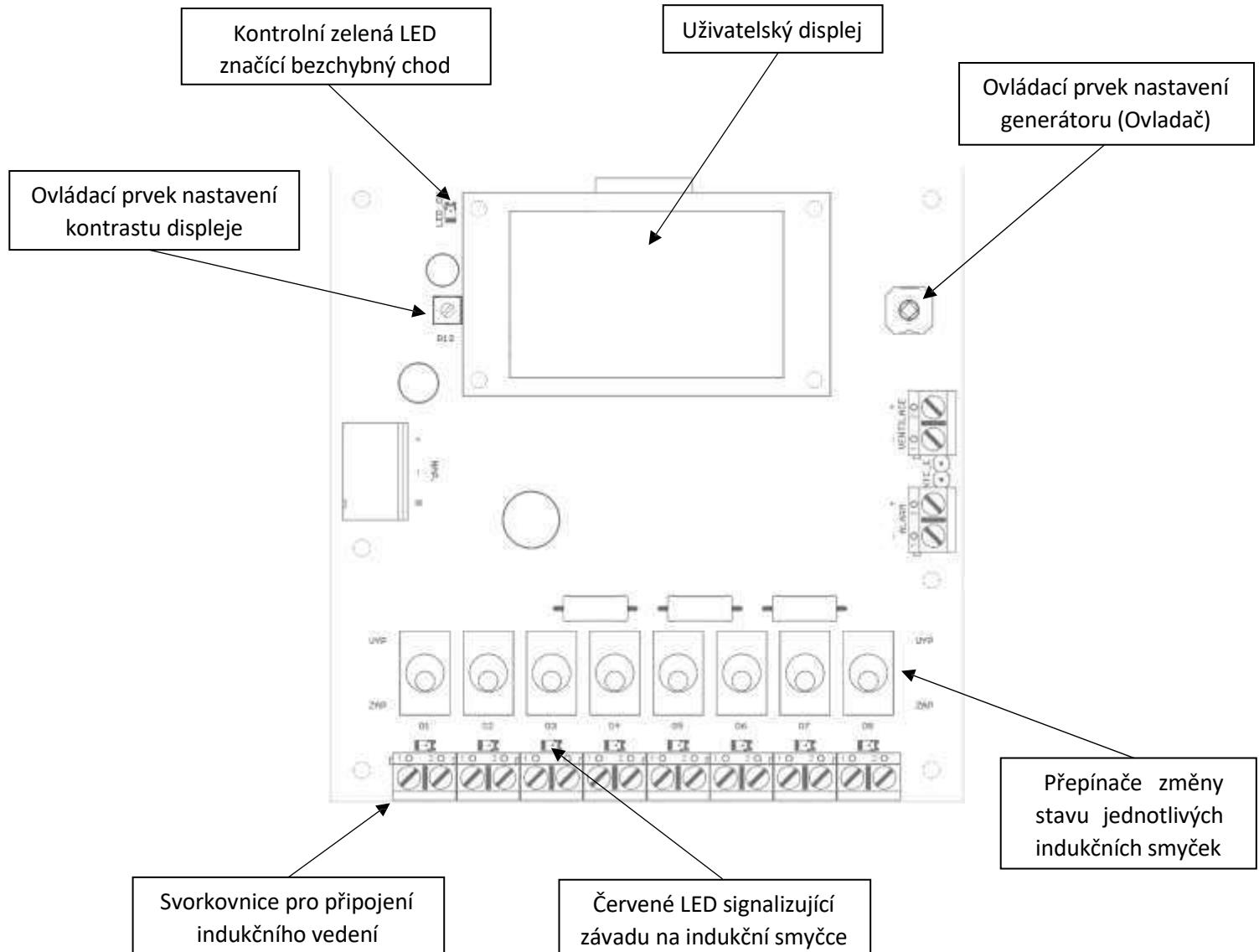
Při běžném provozu se na displeji generátoru zobrazuje verze firmware generátoru a označení dodavatele.
