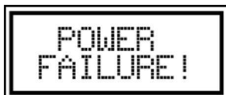
**Po obnovení napájení přestane akustická signálka vydávat tón a displej generátoru opět začne zobrazovat provozní hodnoty. S obnovením napájení je automaticky zahájeno i dobíjení záložního akumulátoru.**
