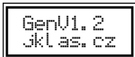
Po stisknutí ovladače generátoru doprava se na displeji zobrazení nastavené hodnoty výstupní frekvence a maximálního výstupního proudu.
