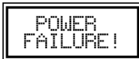
**Nach Erneuerung der Speisung stoppt die akustische Signalvorrichtung einen Ton abzugeben und das Display des Generators zeigt wieder die Betriebswerte an. Mit der Erneuerung der Speisung wird auch automatisch das Aufladen des Ersatzakkumulators begonnen.**
